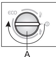
**Uključenje:** gumb **A** okrećite u smjeru kazaljki na satu.
