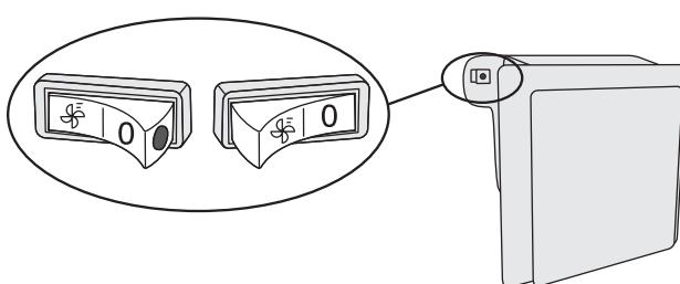
Kada je ventilator uključen, na prekidaču je vidljiva crvena točka.
